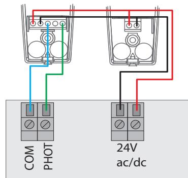
3. Sluit de spanning aan en controleer de uitlijning d.m.v. de rode LED. Indien deze LED oplicht zijn de fotocellen niet goed uitgelijnd of belemert een obstakel de lichtstraal.
